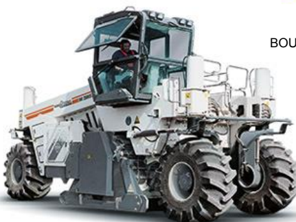
ENGIN STABILISATION TERRAIN
